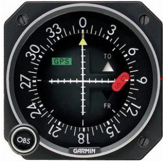
ILS Indicator inside the cockpit
